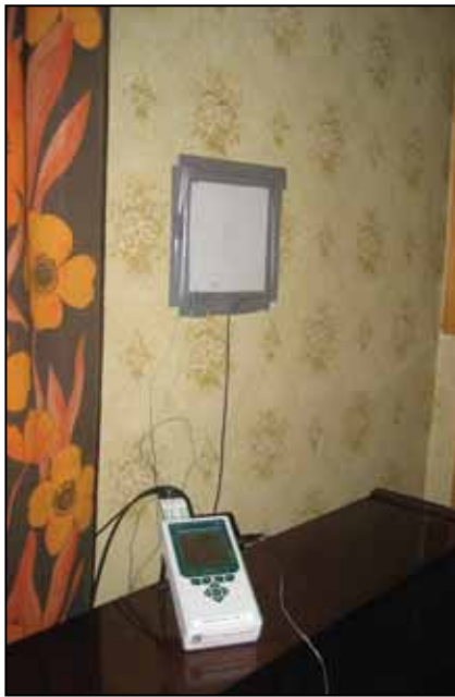
JOONIS 6. SOOJUSVOO MÕÕTMINE KORTERI VÄLISSEINA U-VÄÄRTUSE ARVUTAMISEKS
