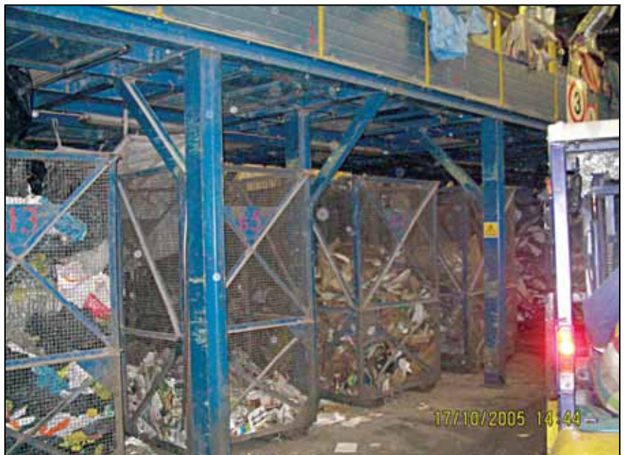
JOONIS 1. TJST-I OLMEPRÜGI KÄSITSISORTIMISLIIN
