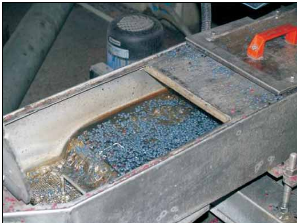
JOONIS 4. KUUMLÕIKAMISEL SAADUD REGRANULAAT (Foto tehtud AS-is Dagöplast)
