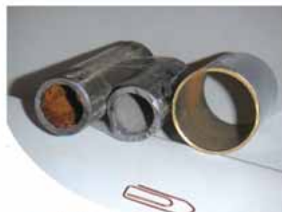
Tsingitud torud enne ja kuus kuud pärast Bauer AK paigaldamist Kadrioru korterühistusse; parempoolne on tükk puhtaks saanud käterätikuivatist
