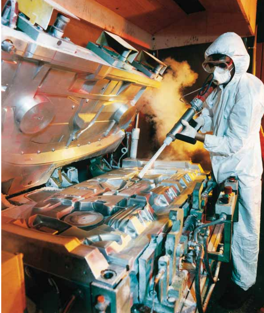
JOONIS 2. KUIVJÄÄPUHASTUSMEETODI CRYOCLEAN® PUHUL PUHASTATAKSE PINDU NAGU LIIVAPRITSIGA, KUID LIIVA ASEMELE PRITSITAKSE PINNALE KUIVJÄÄGRAANULEID. SELLINE PUHASTUSMEETOD SOBIB HÄSTI, KUI EI SAA VÕI EI TAHETA KASUTADA VETT, LAHUSTEID, LIIVA VM PINDA RIKKUVAD AINEID
