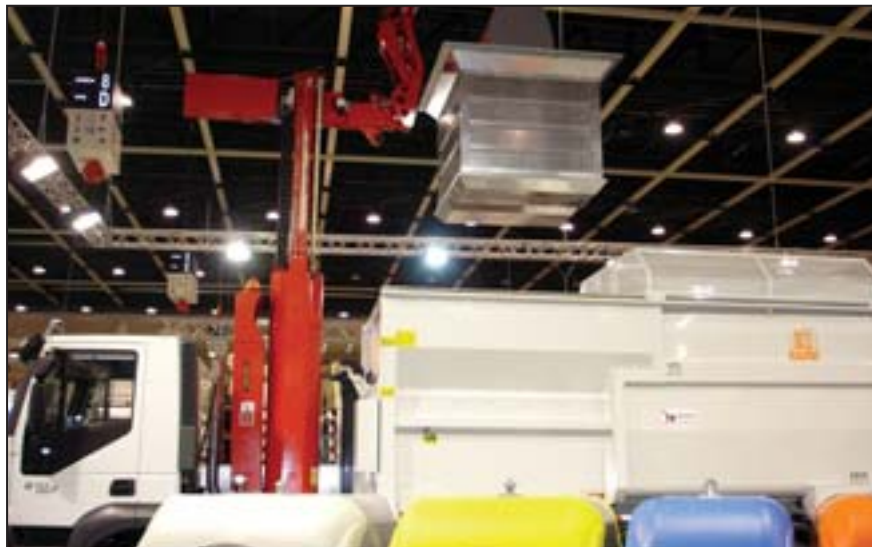
FOTO 1. NORD ENGINEERINGU ALLMAAKONTEINERI TÜHJENDAMINE
