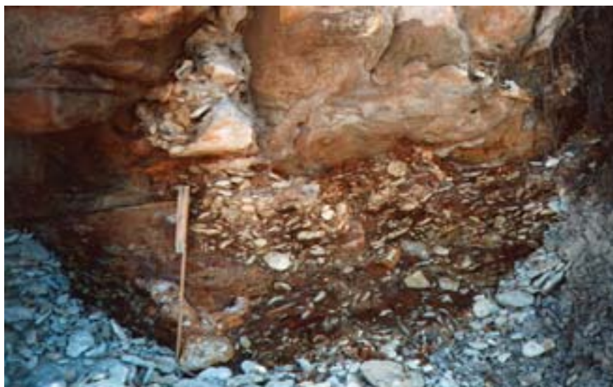
FOTO 3. ALLIKAVEE NÕRGLUBJA PÕHIMÕTTEL OSALISELT TSEMENTEERUNUD RUSUKALDEMATERJAL LÕHETÄITENA
