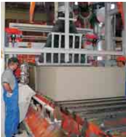
Massiivide mõõtulõikamine Aeroc ASI tehases
