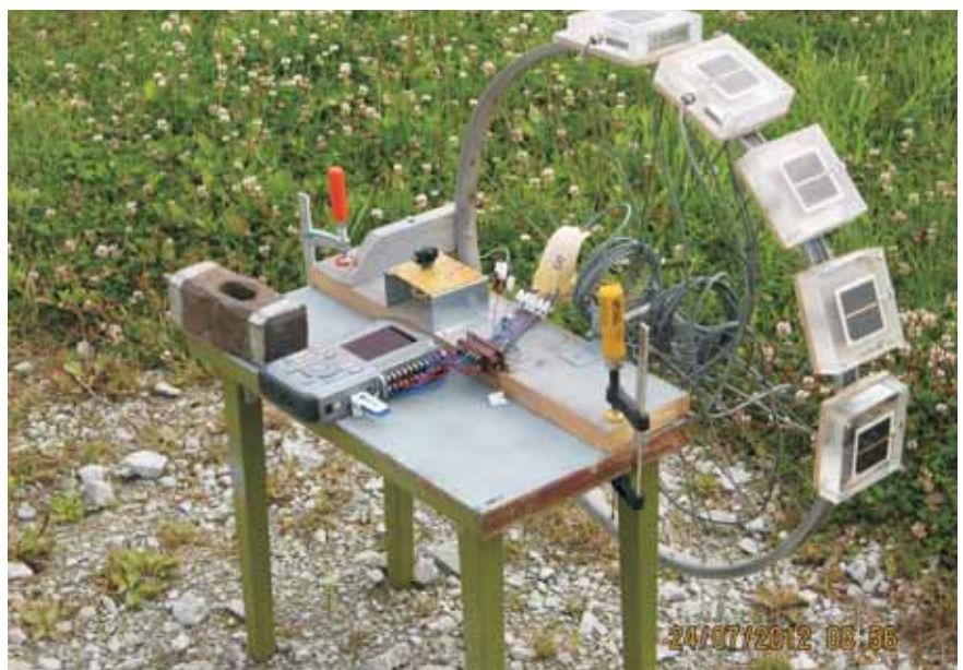
Joonis 4. Stend hajukiirguse mõõtmiseks kiirgust vastu võtvatel kaldpindadel
