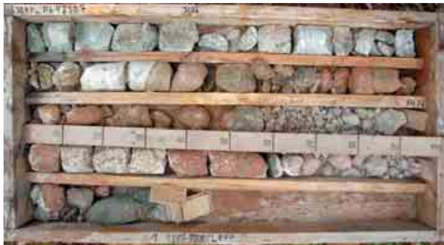
Joonis 4. Paluküla puuraugu P6 südamik sügavuselt 30,4–74 m. Üks neist puuraukudest, mille tõttu uuringutööd Palukülas lõpetati. Sügavusel 31,8 m jõuab puurauk graniitgneisiga esindatud kristalse aluskorra moondekivimiteni, et siis sügavusel 38 m sukelduda alam-kambriumi tugevasti deformeeritud liivakividesse – aleuroliitidesse – ning sügavusel 139,7 m uuesti kristalsetesse alukorda Foto: Tõnis Saadre
