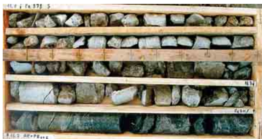
Joonis 1. Paluküla puuraugu nr 378 südamik (migmatiidistunud amfiboliit) sügavuselt 11,0–18,0 m. Kristalne aluskord algab 16,7 m sügavusel. Kattev kivim on Rakvere lademe afaniitne lubjakivi
