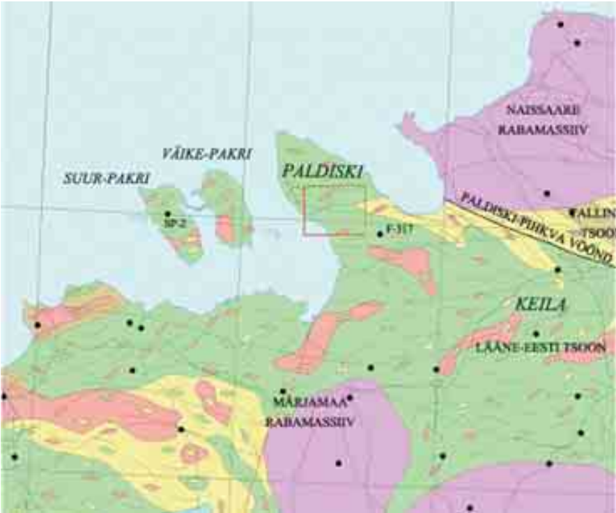
Joonis 12. Paldiski perspektiivala (punase joonega ümbritsetud riskülik) Eesti Geoloogiakeskuse koostatud kristalse aluskorra kaardil. Roheline on biotiit-amfiboolgneisside leviala, roosa rabakivimassiiv, mustad punktid – aluskorda avavad puuraugud ning SP-2 – Suur-Pakri süvapuuraug
