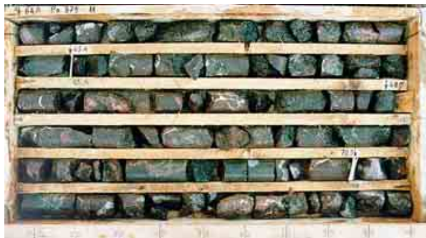
Joonis 2. Paluküla puuraugu nr 379 südamik (migmatiidistunud amfiboliit) sügavuselt 64,0–71,2 m. Lõhesid (valged) täidab kaltsiit
