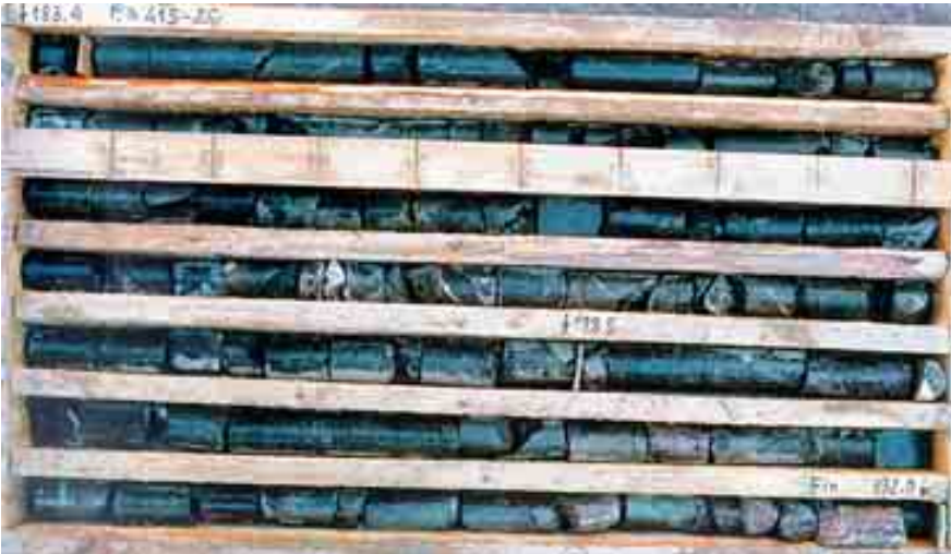
Joonis 3. Paluküla puuraugu nr 415 puursüdamik (migmatiidistunud amfiboliit) sügavuselt 183,4–192,0 m näitab, et ringvall on siiski monoliitne
