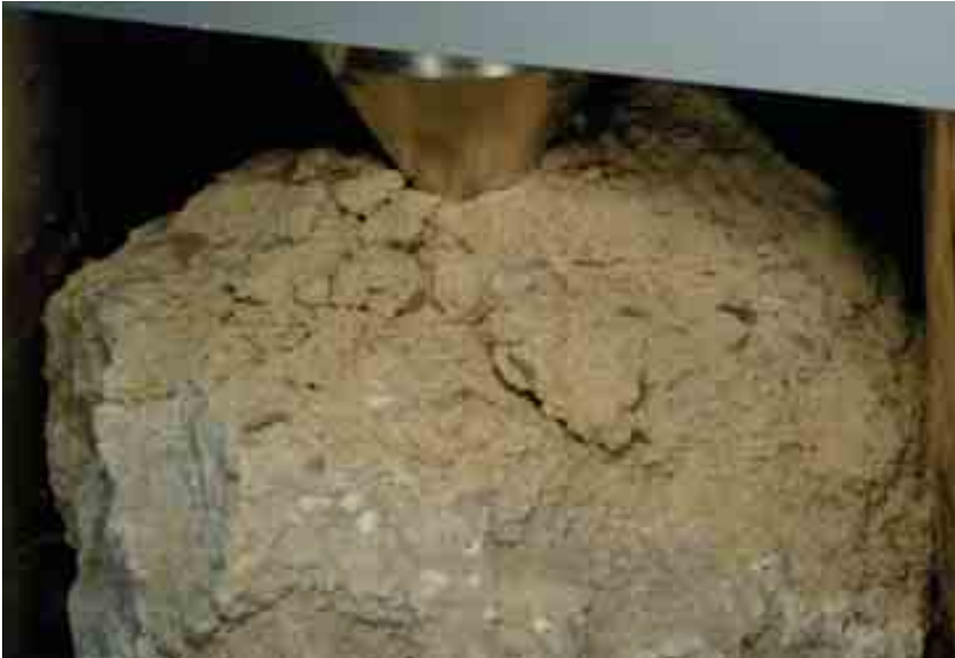
Joonis 2. Ooboluskonglomeraadi käsipala purunemas indentorite vahel punktkoormusteimil (point load testing), mille tulemus – PLT-indeks iseloomustab kivimi vastupanu lõhestamisele ja tõmbele. Fotol nähtavate lingulakarbikeste läbimõõt on umbes 1 cm
