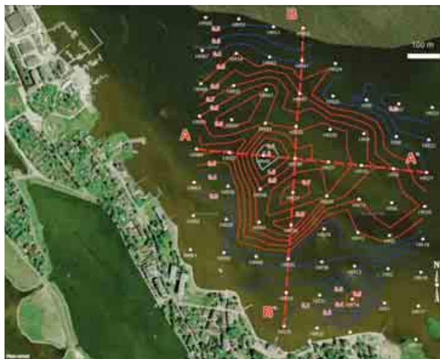
Joonis 2. Meremuda samapaksusjooned ning geoloogiliste läbilõigete ja puuraukude asukohad [49]
