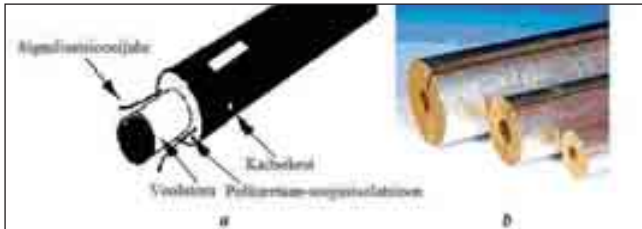
Joonis 9. Eelisoleeritud toru (a) ja kivivillast isolatsioonikoorikud (b)
