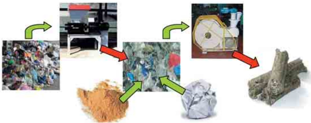
Joonis 1. Brikettide valmistamine olmejäätmetest paberi ja puidutolmu lisamisega [5]
