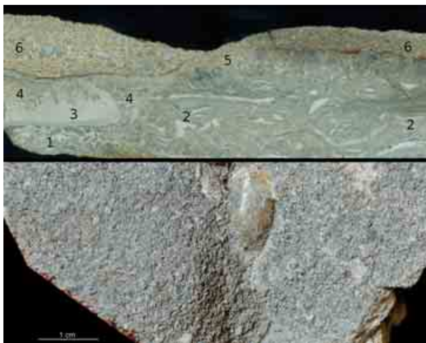
Foto 3. Kipi puursüdamik, sügavus 34,42-34,44 m, lihv ja foto: Veeristega ostrakoodlubjakivi ja ooidlubjakivi kihid läbilõikes (ülal) ja ebasümmeetriliste vooluviredega, üksiku suure karpvähilise kaanega pealtvaates (all). Raskeltjälgitav on hambuline impregnatsioonita kp kiht 2 ja 4 vahel
