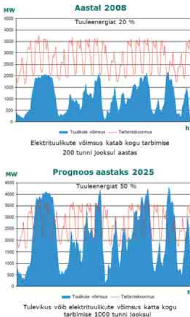
Joonis 1. Lääne-Taani realsed ja prognoositavad koormus- ning elektrituulikute võimsusgraafikud
