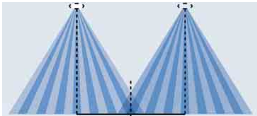
Laes on kaks 360kraadist liikumisandurit. Viirutatud ala on märkamisala
