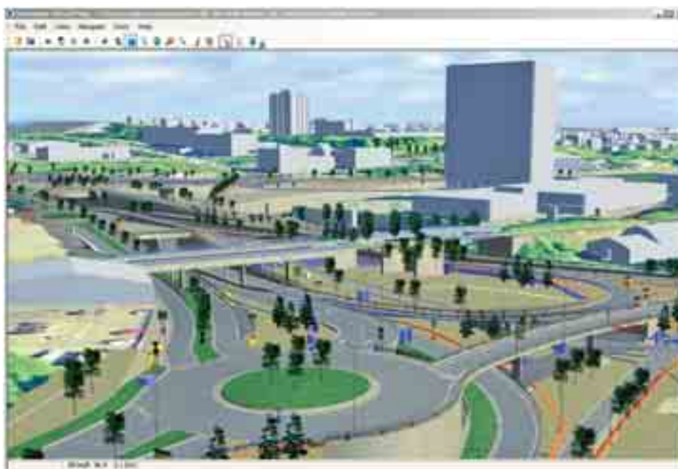
Joonis 6. Teed, sillad ja taristu kõik ühes mudelis (HW 150, Oslo ümbersõit, Vianova Plan og Traffic AS)
