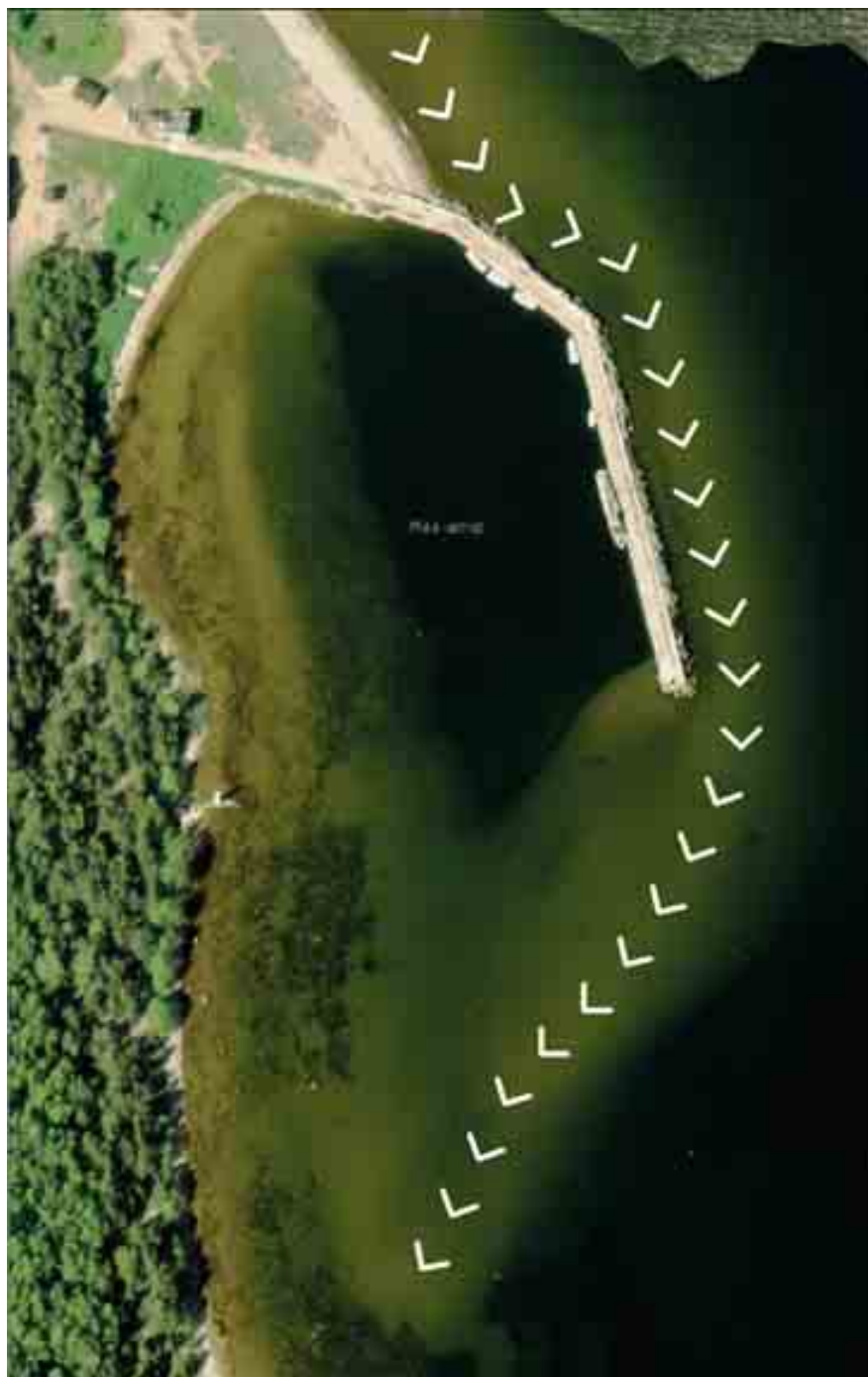
Joonis 6. Liivakehand Naissaare sadama suudmes [9]. Nooltega on tähistatud setete liikumise suund ja liivakehandi telgjoon
