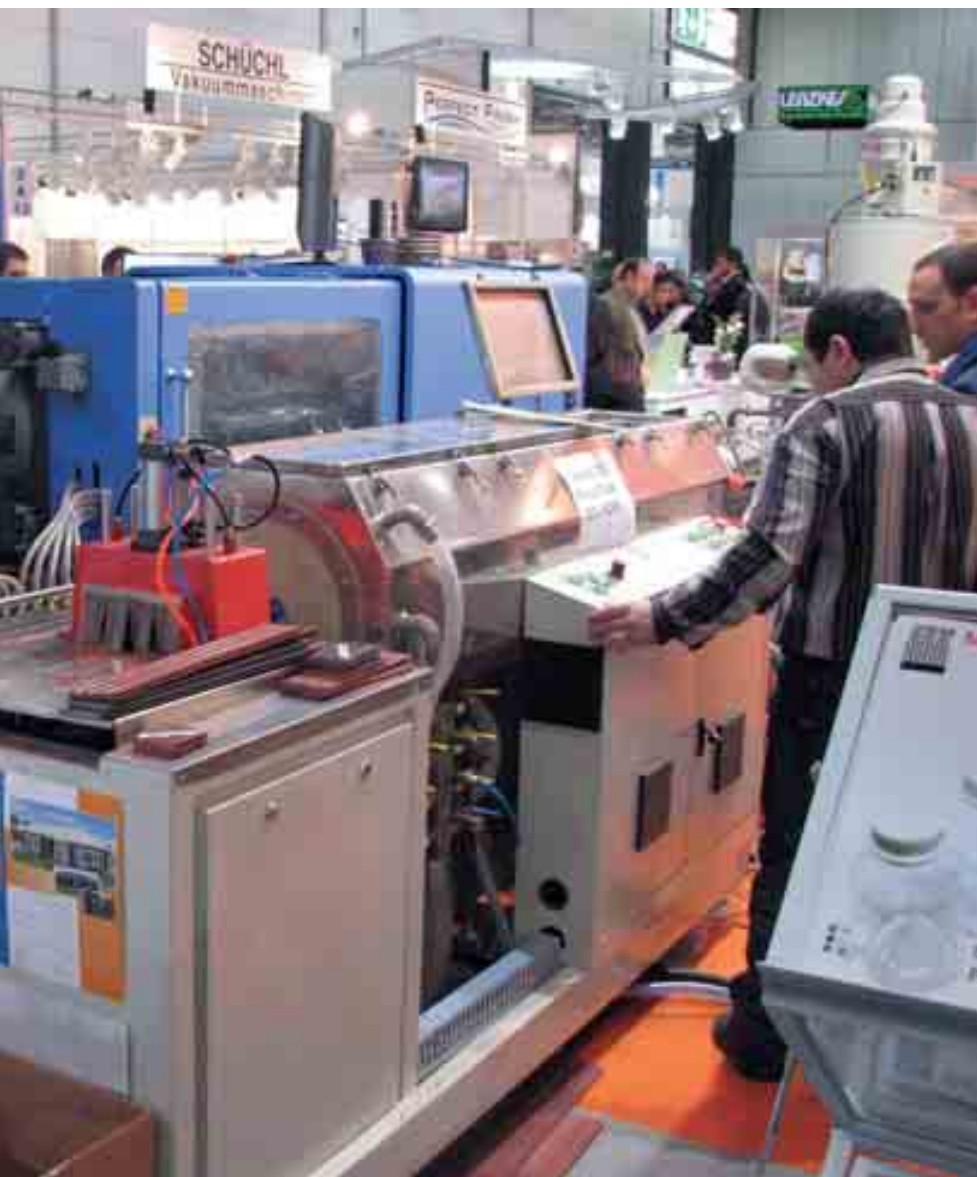
Joonis 3. Puitplastkomposiidist plastprofiilide valmistamine
