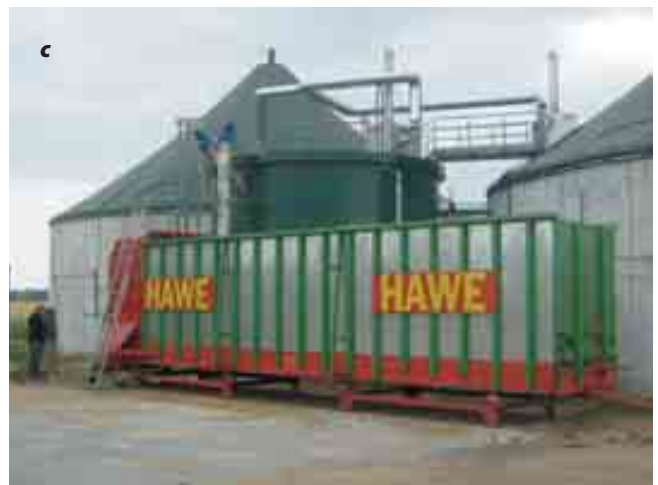
Joonis 4. Kääritite toiteseadmeid: a on pumbatava toorme segur, b tahke toorme annusti, milles üks segur toidab mitut käärtrit (firma Konrad Pumpe) ning c hüdrolüüsimis- ja eelsegamismahuti (firma Hawe-Wester)
