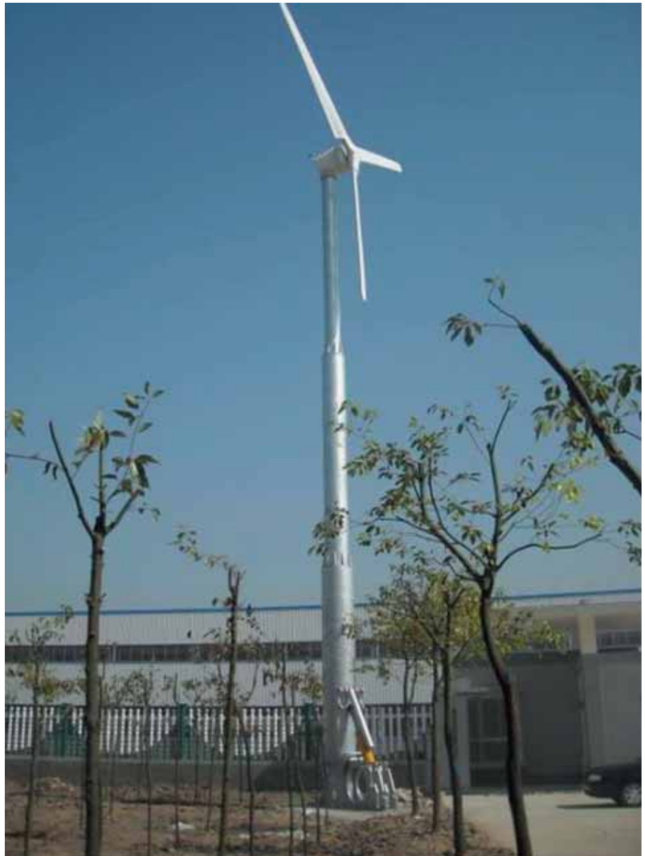
Joonis 1. Hüdrauliliselt langetatava ise püsti seisva mastiga elektrituulik
