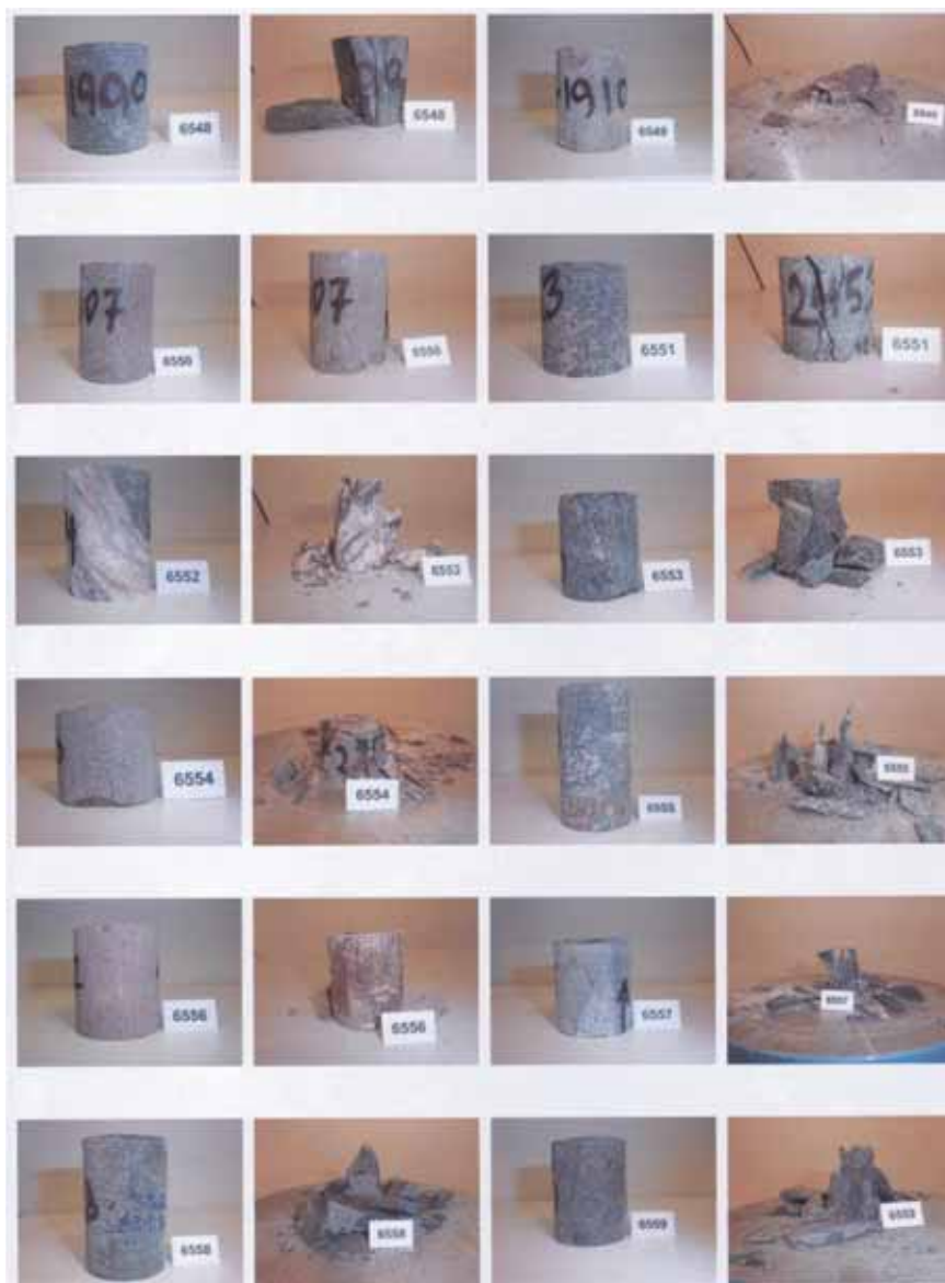
Joonis 7. Puuraugu SP-2 kristalse aluskorra kivimitest survetugevuse määramiseks võetud katsepalad enne ja pärast surveteimi Eesti Keskkonnauuringute Keskuse geotehnikalaboris
