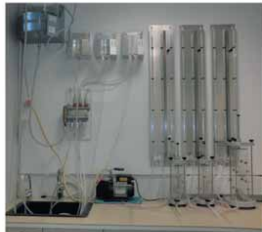
Filtratsiooniseade Controls (FOTO 4)
