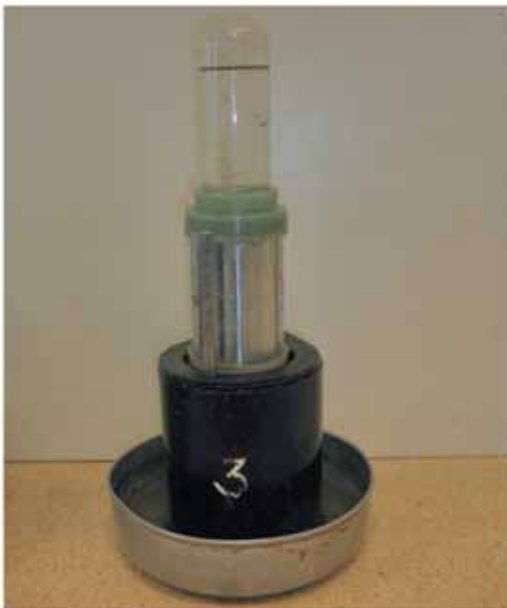
Filtratsiooniseade KF-00 (FOTO 2)
