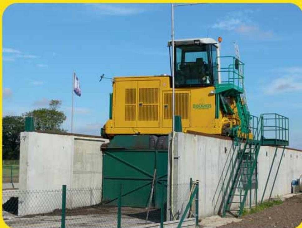
Kompostimine ilmast sõltumata – tunnel-kompostipöorel (Lane Turner) Backhus LT 45 50 DC töötamas kompostimistunnelil
