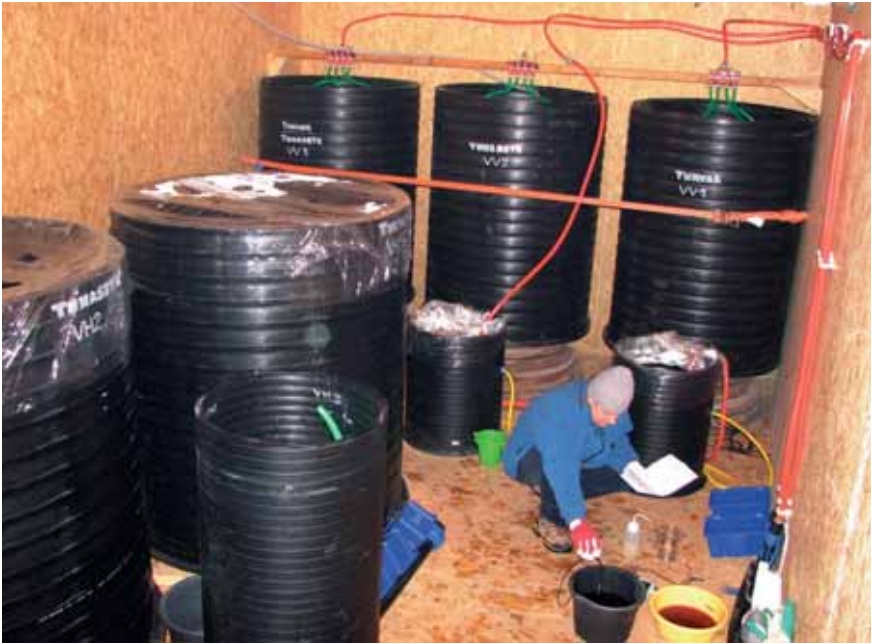
Joonis 2. Prügilanõrgvee järelpuhastuskatse aastatel 2006–2007: tagaplaanil püst- ning ees vasakul rõhtvoolufiltrid
