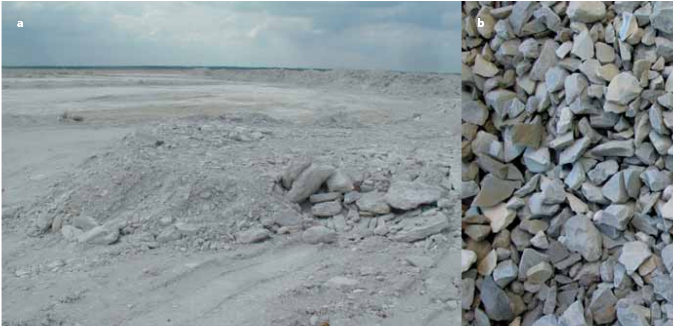
Joonis 1. Põlevkivituhasete: a platool ja b mitmes katses kasutatud 5–20 mm jämedune filtermaterjal
