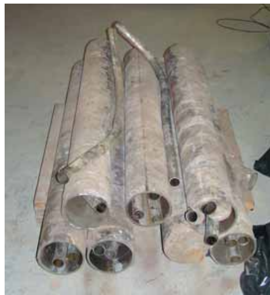
Looduslike radionukliididega saastunud torud Foto: AS A.L.A.R.A.
