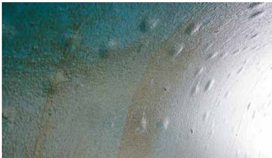
Joonis 2. Osmoosi põhjustatud „villid“ klaasplasti pinnal [10]
