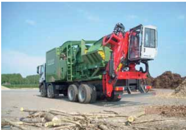
Veoautole paigaldatud Pezzolato PTH-seeria trummelhakkur
