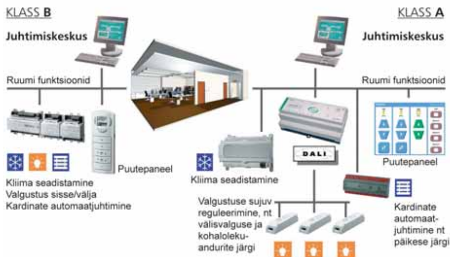
Joonis 1. Tüüpilised B- ja A-klassi büroohoonete automaatikalahendused
