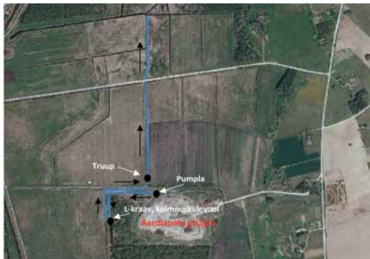
Joonis 1. Aardlapalu prügila ja selle ümbrus. Sinisega on kujutatud nõrgvee liikumist. Veeproove võeti kolmest kohast: pumpla väljavoolust, L-kraavist, prügilataguse metsaga piirneva kraavi keskosas oleva kolmnurkülevoolu juurest ning kraavist ca 10 m allpool truupi
