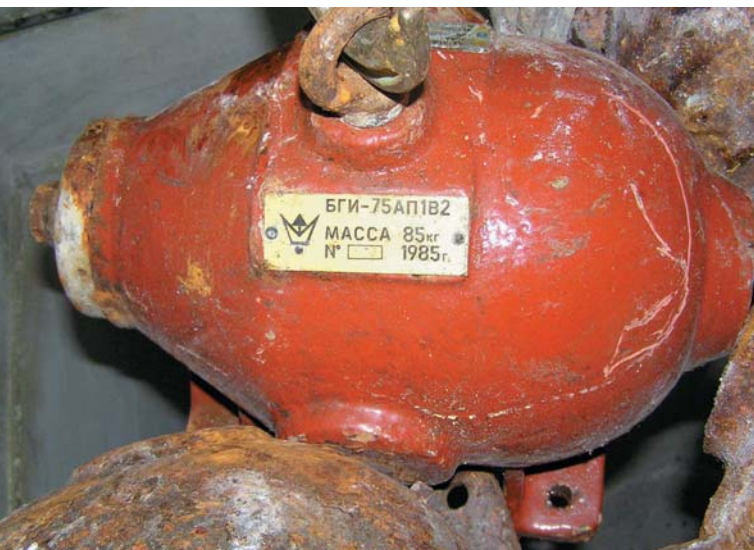
Joonis 2. Nähtava registreerimisnumbriga kiirgusallikakonteiner
