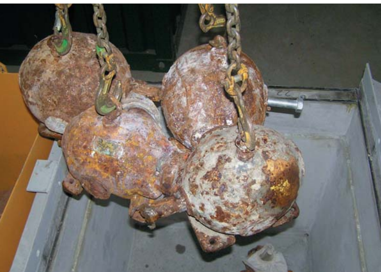
Joonis 1. Roostes kiirgusallikakonteinerid Foto: Ivo Tartik
