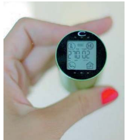
Maailma väikseim (Ø 32 mm, pikkus 62 mm, mass 55 g) O 3 - ja NO 2 -detektor CairWatch Foto: www.cairpol.com
