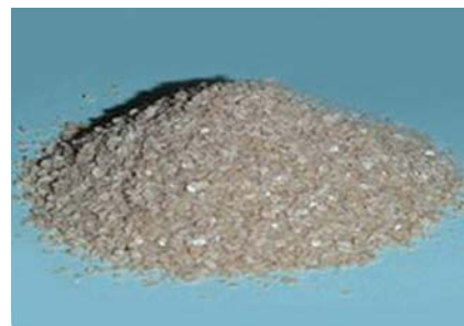
Fosfaatide äraastamisel reoveest NuReSys®-tehnoloogia kohaselt moodustub kristalliline struvite
