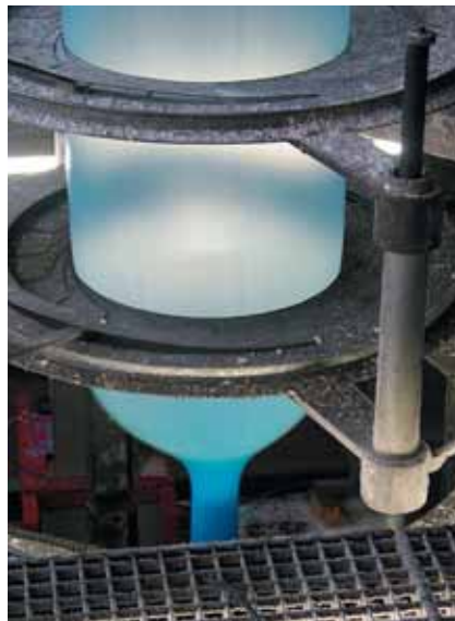
Polüetüleenkile valmistamine puhumismeetodil
