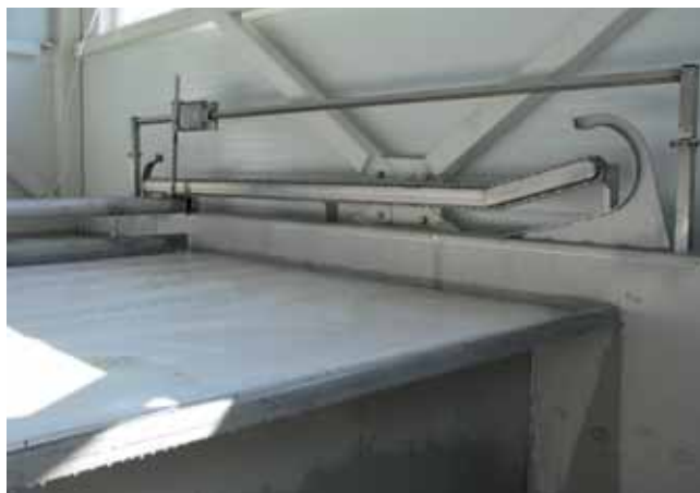
Flotaator (heljum on vahuna pinnale kerkinud)
