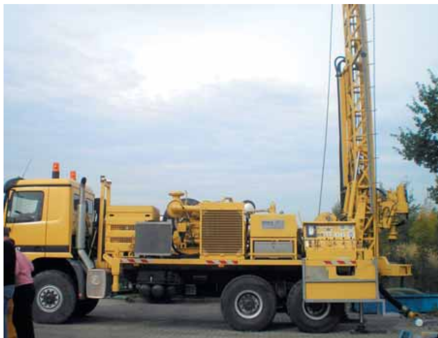
Joonis 2. Liigutatava rootoriga puurmasin BAUER RB40, mis on mõeldud suure läbimõõduga ning kuni 800 m sügavuste ühisveevärgi kaevude puurimiseks
