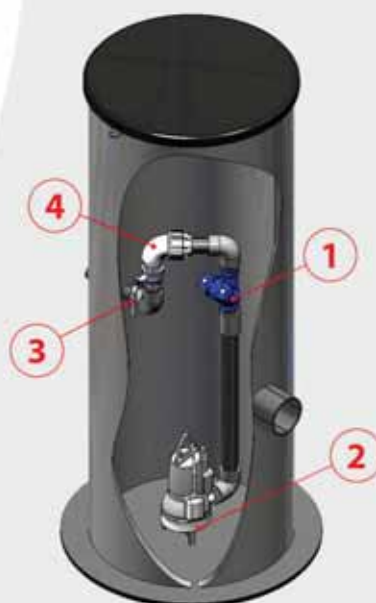
Joonis 2. Väikepumpla Strong Private: 1 on tagasivooluklapp, 2 pump, 3 kuulkraan, 4 keermesliitmik
