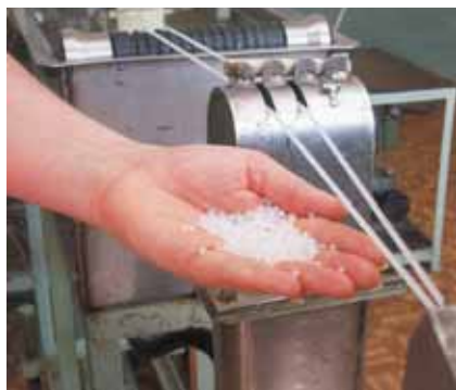
Joonis 4. Polükoarbonaatmaterjalide jäätmetest toodetud polümeerset komposiitmaterjali saab kasutada nt auto- ja elektroonikatööstuses ning elektrimaterjalide tootmisel
