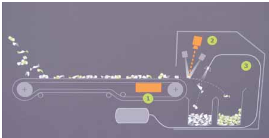
Joonis 2. Eri värvi pakendite sortimisliin Titech : 1 – elektromagnetiline metallidetektor, 2 – RGB-kaamera, 3 – sortimiskamber
