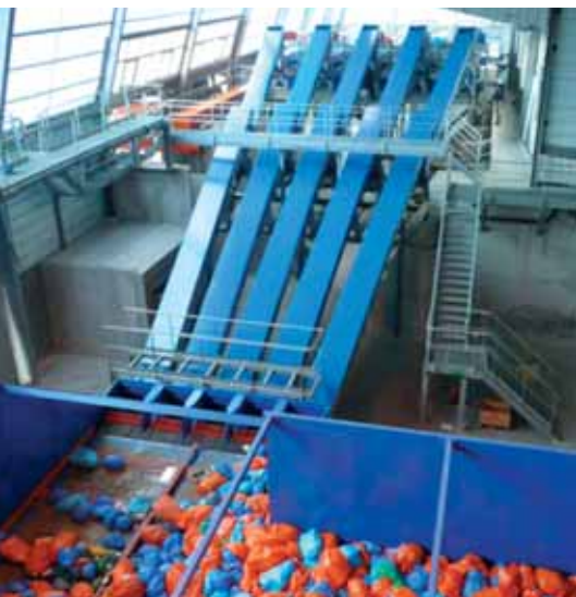
Joonis 3. Optiline jäätmekotisorter Bagtronic [4]
