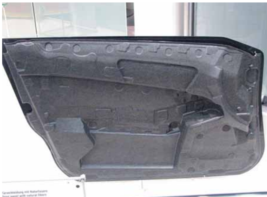
Joonis 3. Looduslike kiududega sarrustatud termoplastist survevalu-autouukse sisepaneel
