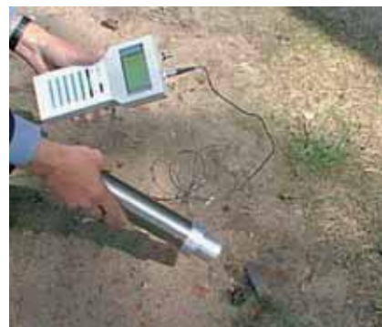
Joonis 4. \gamma -Mapperit on lihtne kasutada, see ei nõua eriväljaõpet. Pildil on seadme eelmine versioon
