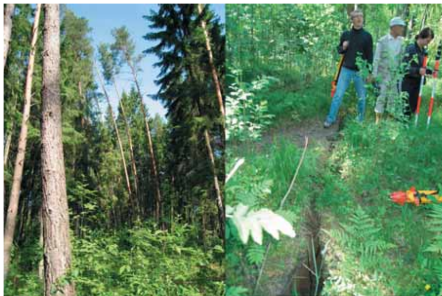
Joonis 5. Estonia varingu murdejoonel on näha puude kaldumist varingu suunas
